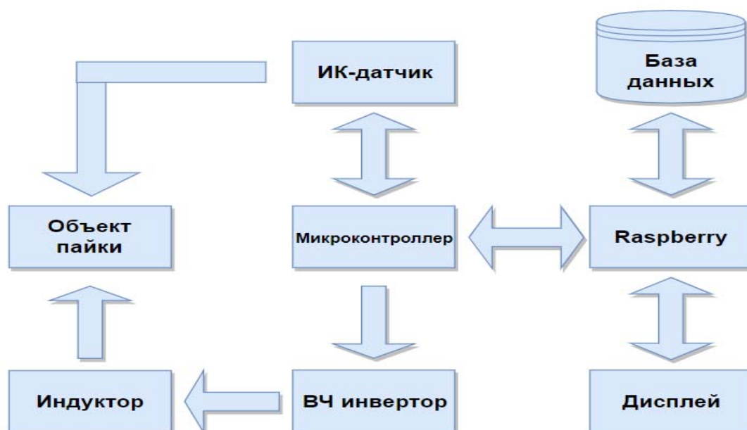
Рисунок 3 – Схема установки контроля параметров индукционной пайки
