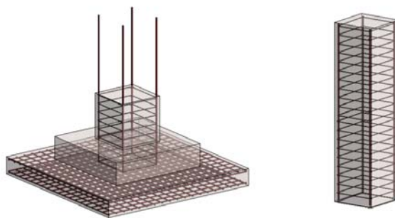
Рисунок 1 – Модели монолитных фундамента и колонны с армированием
