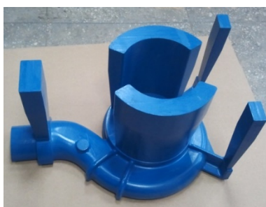
а б в Рисунок 3 – Примеры исполнения модельной оснастки: а – модель корпуса с литниковой системой (МДФ и пластики: PROLAB 65 и LAB 850), б – модель корпуса насоса (пластик - LAB 850), в – модельная оснастка (МДФ и пластики: PROLAB 75 и LAB 850)
