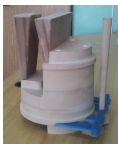
а б в Рисунок 3 – Примеры исполнения модельной оснастки: а – модель корпуса с литниковой системой (МДФ и пластики: PROLAB 65 и LAB 850), б – модель корпуса насоса (пластик - LAB 850), в – модельная оснастка (МДФ и пластики: PROLAB 75 и LAB 850)
